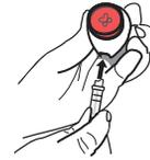
4. Enfoncez le tube à fond dans le dispositif avec les lignes de remplissage vers l'extérieur.
