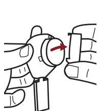
5. Entfernen Sie die transparente Kunststoffabdeckung über der roten Taste.
